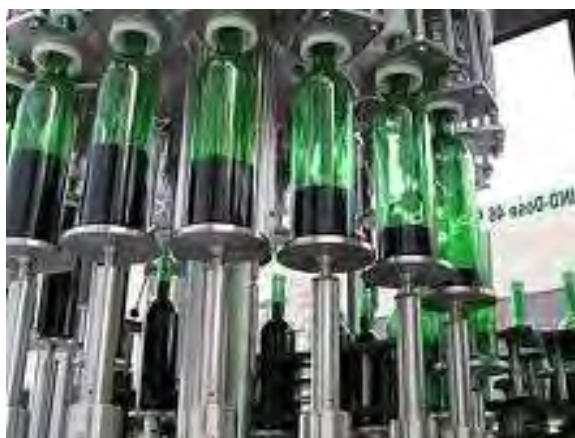
Figura 11. Makineri mbushës që përdoren në impjantet e ditëve të sotme.
