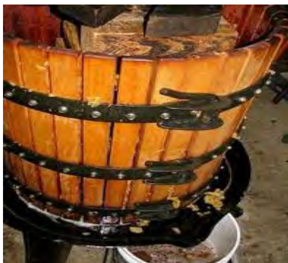
Figura 2. Procesi i shtypjes së rrushit sipas mënyrës tradicionale me peshë nga sipër.
