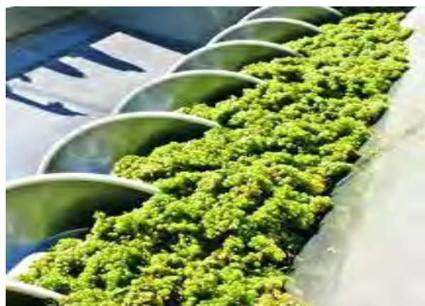
Figura 3. Pamje e presave të pajisura me shnek lëvizës.
