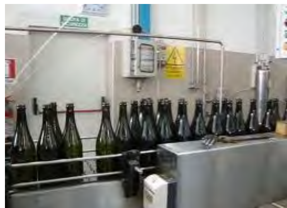
Figura 5. Moment tjetër i kalimit të shisheve në rrjet nëpërmjet të cili shishet kalojnë në transportier para se të mbushen
