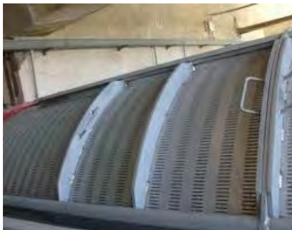
Figura 4. Pamje e një presese të vazhdueshme e cila përdoren na kantinat me kapacitet të madh
