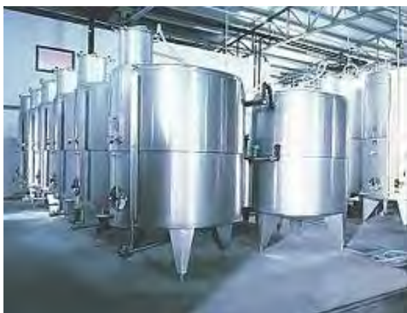
Figura 6. Pamje e depozitave në të cilat realizohet rifermentimi i verërave.
