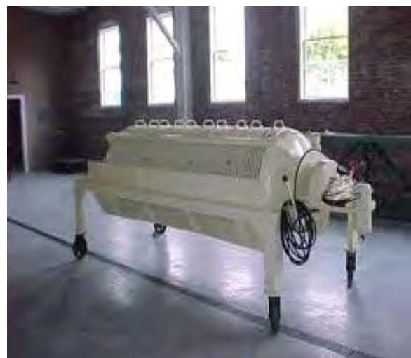
Figura 5. Lloj tjetër prese që përdoret në linjat e përpunimit të rrushit (pneumatike).
