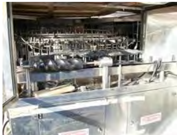
Figura 19. Pamje një makinerie moderne e cila përdoret për mbushjen e shisheve të verës.
